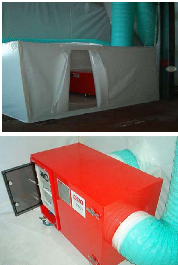
Figura 4: Sistema di estrazione dell'aria
